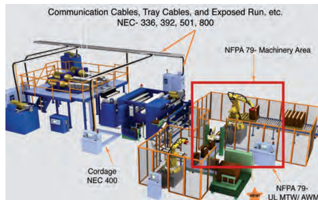
Схематическое изображение промышленного оборудования показывает основное применение кабелей и проводов со ссылкой на NEC®/NFPA. “NEC®” – торговая марка Национальной ассоциации пожарной безопасности.
